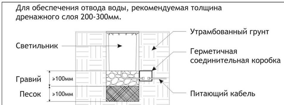
РИС.2. Схема дренажа
