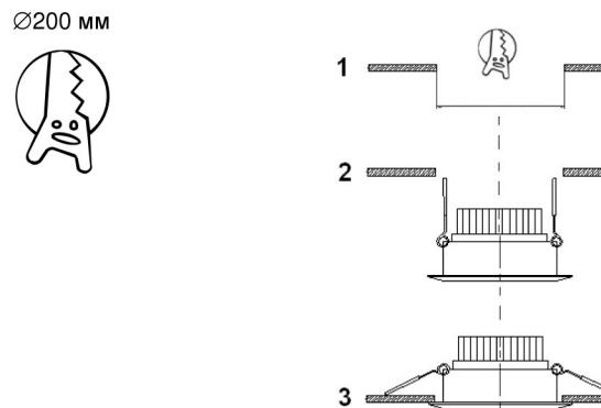
Рис.1. Установка светильника
